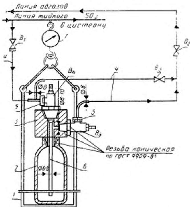
1 — корзина подвески баллона к динамометру; 2 — баллон; 3 — насадка для баллона; 4 — трубка для подсоединения баллона к линии жидкого сернистого ангидрида и линии абзавов; 5 — нахлестные гайки; 6 — сифон; 7 — динамометр;  $B_1$  и  $B_4$  — вентили для жидкого сернистого ангидрида;  $B_2$  и  $B_3$  — абзавные вентили;  $B_5$  — вентиль для эвакуации сернистого ангидрида из линии жидкого сернистого ангидрида
