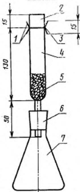
1—стеклянные крючки; 2, 4—стеклянные трубки; 3—бромнортутная бумага; 5—вата, смоченная раствором уксуснокислого свинца; 6—резиновая пробка; 7—коническая колба.
