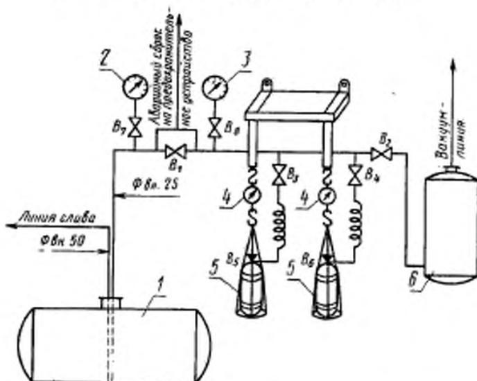
1—цистерна (хранилище); 2—манометр; 3—мановакуумметр; 4—динамометр или весы; 5—баллон; 6—испаритель;  $V_1, V_2$ —вентили по ГОСТ 20294—74;  $V_3, V_4$ —вентили по ГОСТ 5.1723—72;  $V_5, V_6$ —вентили баллонные;  $V_7, V_8$ —вентили по ГОСТ 4345—77.
