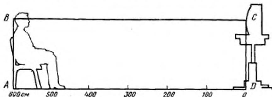
*ABCD* — вертикальная плоскость, проходящая через центр экрана прибора типа ПОЗД-2 и центр спинки стула испытуателя; *AD* — шкала расстояний; *AB* — вертикаль, проходящая через спинку стула; *CD* — вертикаль, опущенная из центра экрана.
