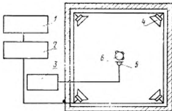
1—аудиометр (генератор); 2—усилитель мощности; 3—шумомер; 4—громкоговоритель; 5—микрофон шумомера; 6—испытуемый.
