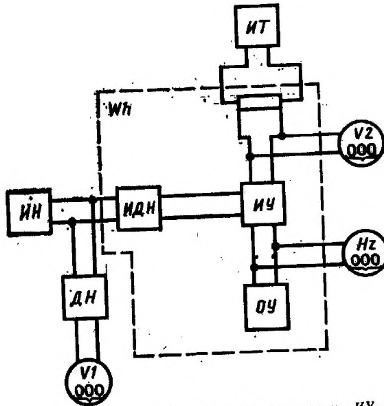
*ИДН*—индивидуальный делитель напряжения; *ИУ*—измерительное устройство; *ОУ*—отсчетное устройство; *ДН*—образцовый делитель напряжения; *Hz*—образцовый частотомер-хронометр; *ИН*—источник постоянного напряжения; *ИТ*—источник постоянного тока; *V1* и *V2*—образцовые вольтметры
