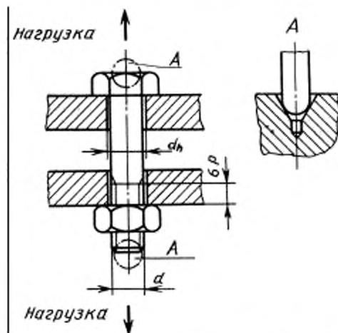
$d_h$  — диаметр отверстия по второму ряду ГОСТ 11284;  $A$  — требуемый вид контакта между сферической поверхностью измерительного штифта и конической поверхностью отверстия в торце болта
