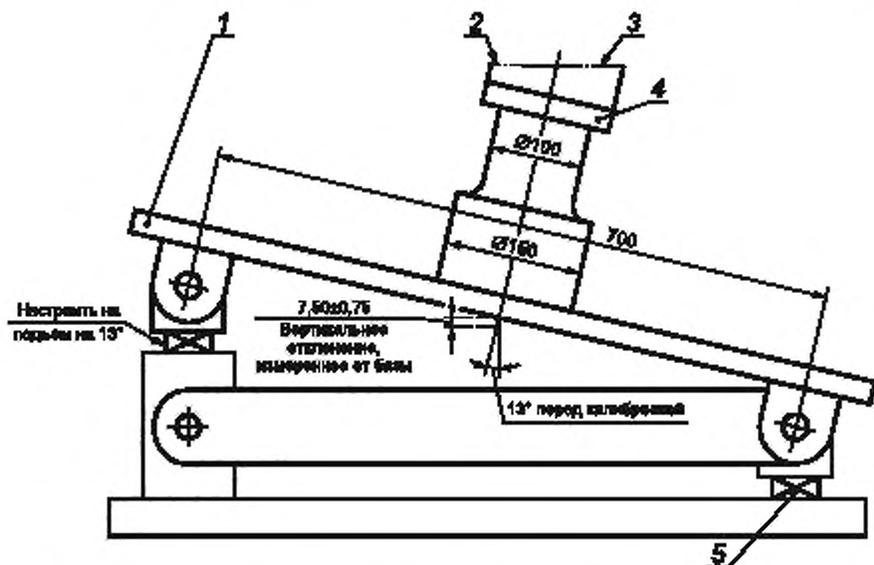
1 — стальной брус 200 × 25 мм, 2 — нагрузка для калибровки 1000 кг, 3 — переходник для калибровки;
