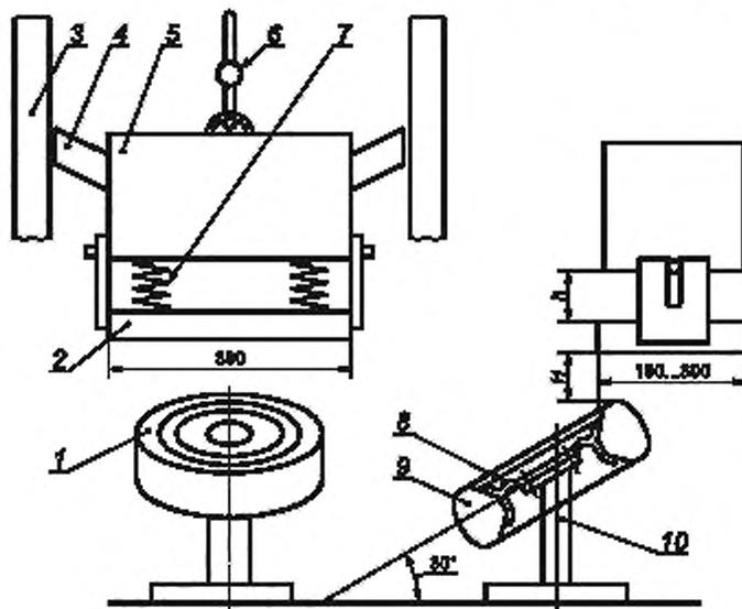
1 — колесо в сборе; 2 — дополнительный груз; 3 — рама; 4 — направляющая; 5 — основной груз;
