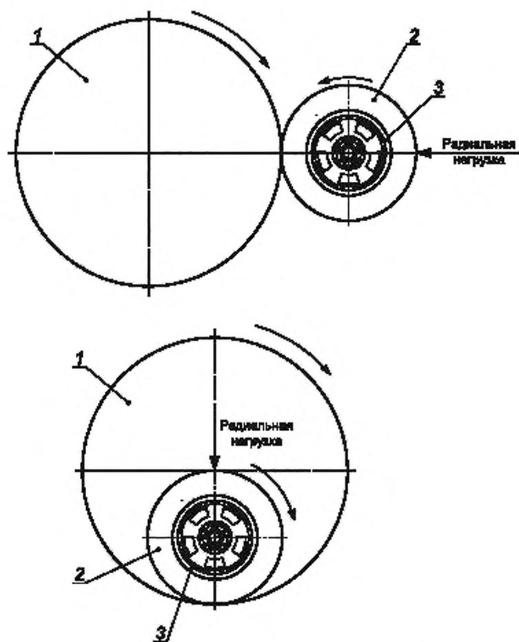
1 — приводной вращающийся барабан; 2 — шина; 3 — колесо
