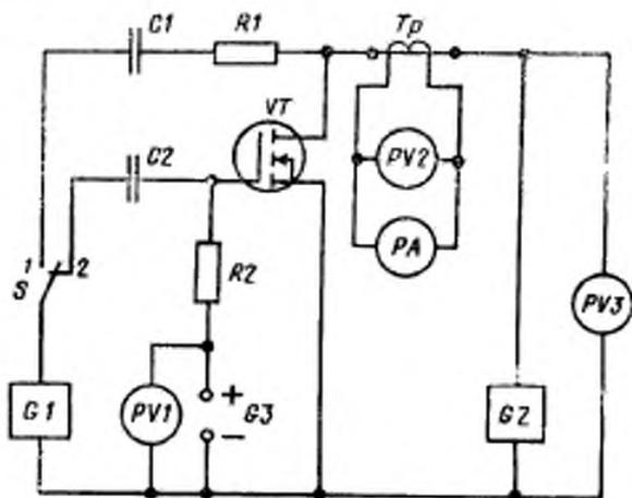
*G1, C2*—разделительные конденсаторы; *R1, R2*—резисторы; *Tp*—импульсный трансформатор тока; *VT*—измеряемый транзистор; *PV2*—измеритель переменного напряжения; *S*—переключатель; *PA*—импульсный измеритель тока; *PV3*—импульсный вольтметр; *G1*—генератор; *PV1*—вольтметр постоянного тока; *G3*—источник постоянного напряжения; *G2*—источник импульсного напряжения
