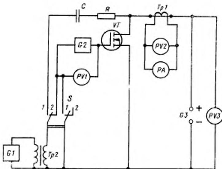
*C* — разделительный конденсатор; *R* — резистор; *Tr1* — импульсный трансформатор тока; *G2* — источник импульсного напряжения; *VT* — измеримый транзистор; *PV2* — измеритель переменного напряжения; *PV1* — импульсный вольтметр; *PA* — импульсный измеритель тока; *S* — переключатель; *G3* — источник постоянного напряжения; *PV3* — вольтметр постоянного тока; *G1* — генератор; *Tr2* — трансформатор переменного напряжения
