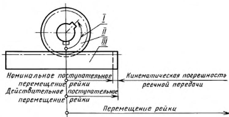
*I* — действительный угол поворота зубчатого колеса; *II* — зубчатое колесо; *III* — рейка
