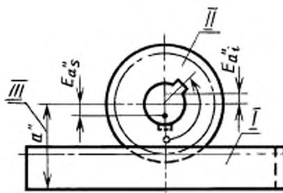
I — контролируемая зубчатая рейка; II — измерительное зубчатое колесо;
