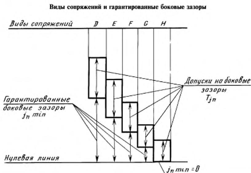
Виды сопряжений в реечной передаче в зависимости от степени точности по нормам плавности работы указаны в табл. 1.
