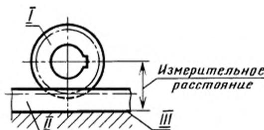
$I$  — измерительное зубчатое колесо;  $II$  — контролируемая зубчатая рейка;  $III$  — базовая опорная поверхность
