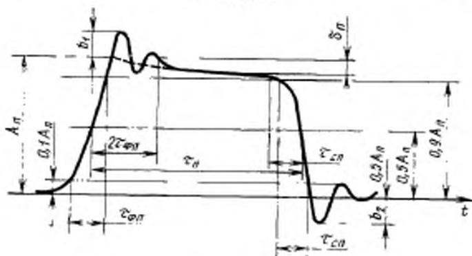
$A_n$  — высота прямоугольного импульса, находится путем продолжения плоской части вершины до пересечения с фронтом прямоугольного импульса;  $\tau_n$  — длительность прямоугольного импульса;  $\tau_{фл}$  — длительность фронта прямоугольного импульса;  $\tau_{сп}$  — длительность среза прямоугольного импульса;  $b_1$  — выброс на вершине прямоугольного импульса;  $b_2$  — выброс в паузе прямоугольного импульса;  $\delta_n$  — неравномерность вершины прямоугольного импульса
