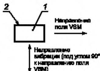
1 — образец; 2 — кромка образца
