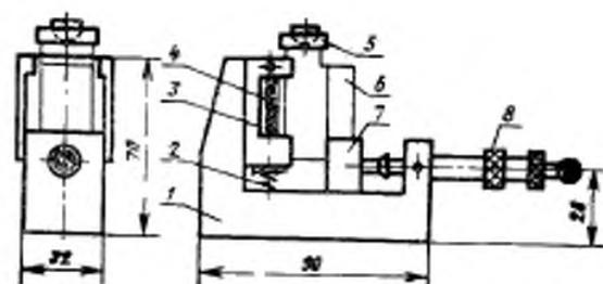
1—корпус; 2—пружина; 3—подвижная вставка; 4—ролики;
