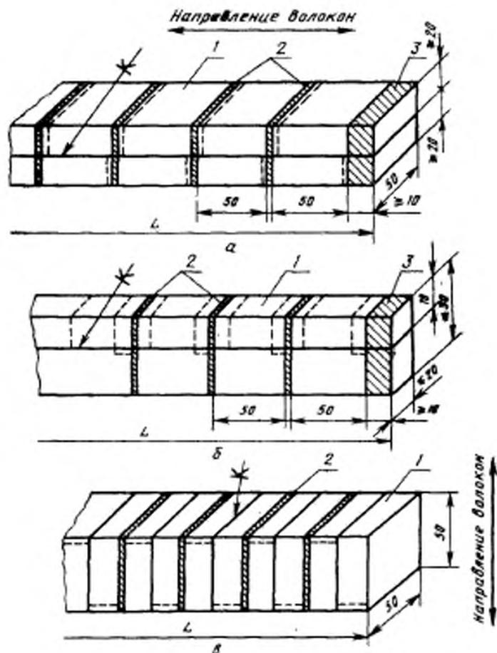
1—заготовка для образца; 2—провил; 3—приспуск на обработку
