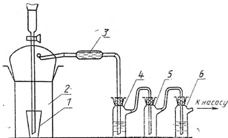
1 — никелевый тигель с охлажденным расплавом, 2 — реакционный сосуд; 3 — трубка с силикагелем, пропитанным концентрированной серной кислотой; 4 — приемник фтора, содержащий 15 см<sup>3</sup> дистиллированной воды; 5 — промежуточная емкость; 6 — приемник углекислого газа, содержащий 15 см<sup>3</sup> аммиачного раствора хлорида бария
