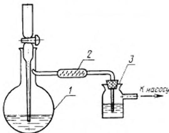
1—реакционная колба; 2—трубка с силикагелем, пропитанным концентрированной серной кислотой; 3—приемник фтора, содержащий  $15\text{ см}^3$  дистиллированной воды
