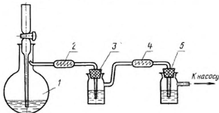
1—реакционная колба; 2, 4—трубки с смазкой, пропитанной концентрированной серной кислотой; 3—приемник фтора, содержащий 15 см<sup>3</sup> дистиллированной воды; 5—приемник углекислого газа, содержащий 15 см<sup>3</sup> аммиачного раствора хлорида бария
