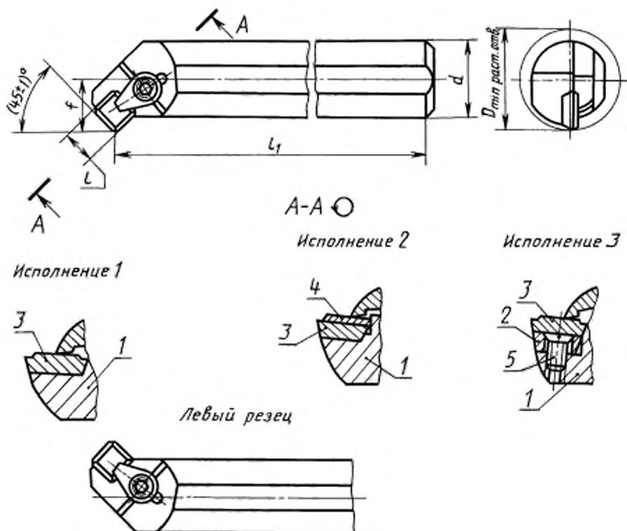
1 — державка; 2 — опорная пластина по ГОСТ 19077—80; 3 — режущая пластина по ГОСТ 19050—80, ГОСТ 24252—80;
