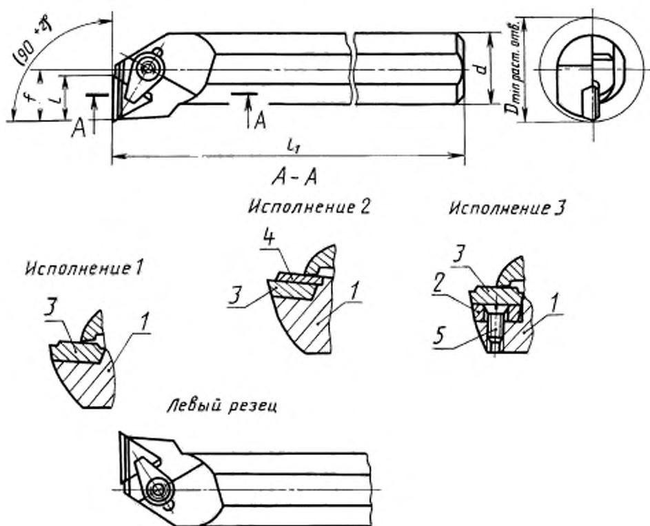
1 — державка; 2 — опорная пластина по ГОСТ 19074—80; 3 — режущая пластина по ГОСТ 19045—80;
