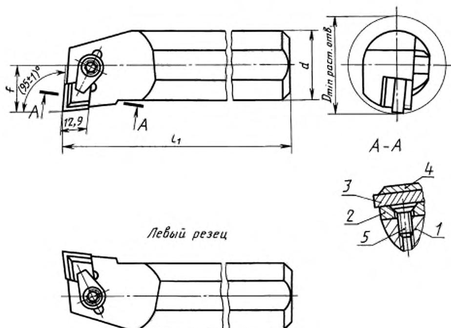
1 — державка; 2 — опорная пластина по ГОСТ 19078—80; 3 — режущая пластина по ГОСТ 25003—81, ГОСТ 19056—80;
