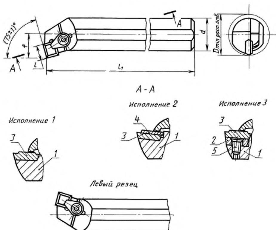
1 — державка; 2 — опорная пластина по ГОСТ 19077—80; 3 — режущая пластина по ГОСТ 19050—80, ГОСТ 24252—80;
