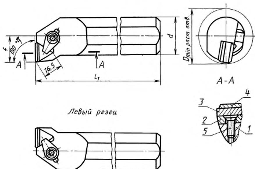
1 — державка; 2 — опорная пластина по ГОСТ 19073—80; 3 — режущая пластина по ГОСТ 25003—81, ГОСТ 19043—80;
