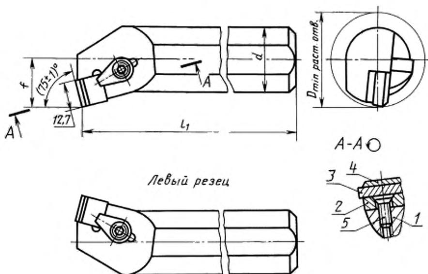
1 — державка; 2 — опорная пластина по ГОСТ 19076—80; 3 — режущая пластина по ГОСТ 25003—81, ГОСТ 19049—80;
