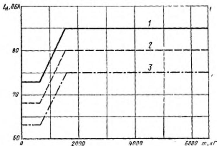
1—нормы для контрольной точки, расположенной на удалении 2500 м по оси ВПП от начала разбега; 2—исходные нормы для горизонтального пролета самолета на высоте 300 м; 3—целевая норма для горизонтального пролета на высоте 300 м для самолетов, выпуск которых продолжится после 1 января 1990 г.
