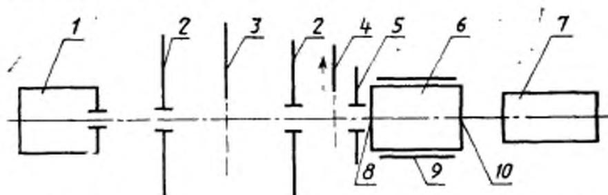
1—источник света; 2—светозащитная диафрагма; 3—заслонка; 4—непрозрачный диск; 5—диафрагма; 6—ЭОП; 7—яркомер; 8—фотокатод; 9—держатель ЭОП; 10—окан
