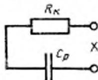
$R_K$ —калибровочный резистор;  $C_P$ —разделительный конденсатор
