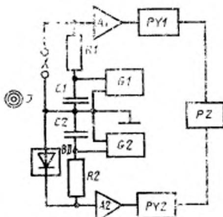
*I*—источник импульсов ионизирующего излучения; *X*—входные выводы установки; *BD*—ППД-монитор; *R1*, *R2*—резисторы утечки; *C1*, *C2*—блокирующие конденсаторы; *A1*, *A2*—зарядочувствительные усилители; *G1*, *G2*—источники рабочего напряжения; *PY1*, *PY2*—интегрирующие измерители; *PZ*—измеритель отношений сигналов
