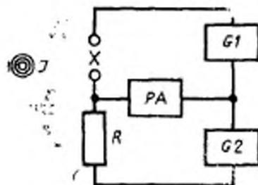
*J*—источник ионизирующего излучения; *X*—входные выводы установки; *R*—компенсационный резистор; *PA*—измеритель тока; *G1*—источник рабочего напряжения; *G2*—источник компенсирующего напряжения
