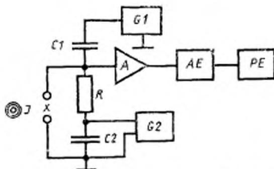
*I*—источник нормализующего излучения; *X*—ходные выводы установки; *C1*—дозиметрический конденсатор; *R*—резистор утечки; *C2*—блокирующий конденсатор; *G1*—генератор импульсов напряжения; *A*—ЗУ; *G2*—источник рабочего напряжения; *AE*—масштабный преобразователь; *PE*—амплитудный анализатор
