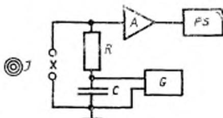
*I*—источник ионизирующего излучения; *X*—входные выводы уста
