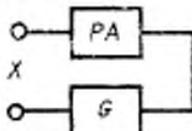
X—входные выводы установки; РА—измеритель постоянного тока; Г—источник рабочего напряжения
