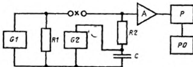
G1—генератор импульсов; R1—резистор нагрузки генератора; X—выводы для подключения ППД; G2—источник рабочего напряжения; R2—резистор утечки; C—блокирующий конденсатор; A—ЗУ; P—измеритель амплитуды; PD—корректор нуля
