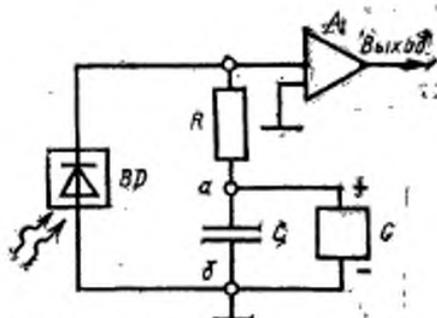
ВД—ППД; А—зарядочувствительный усилитель (ЗУ); R—резистор утечки; С—блокирующий конденсатор; G—источник рабочего напряжения; а, б—точки подключения рабочего напряжения
