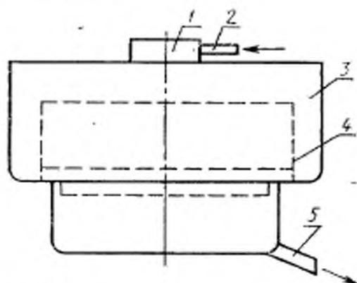
1—брызгалка гидроротационная; 2—штуцер подачи промывной воды; 3—корпус приставки; 4—сито; 5—патрубок для вывода подрешетного продукта
