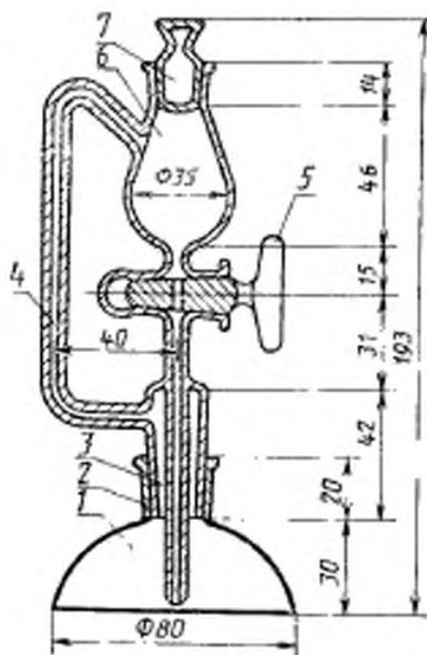
1—подставка; 2—горловина подставки со шлифом; 3—пробка с наружным шлифом; 4—газоотводная трубка; 5—соединительный односторонний кран; 6—резервуар грушевидной формы; 7—притертая пробка
