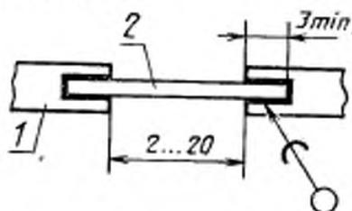
1 — поврежденный печатный проводник; 2 — перемычка
