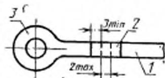
1 — поврежденный печатный проводник; 2 — перемычка; 3 — контактная площадка
