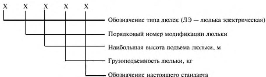
Пример условного обозначения люльки электрической третьей модификации с наибольшей высотой подъема 150 м и грузоподъемностью 200 кг:
