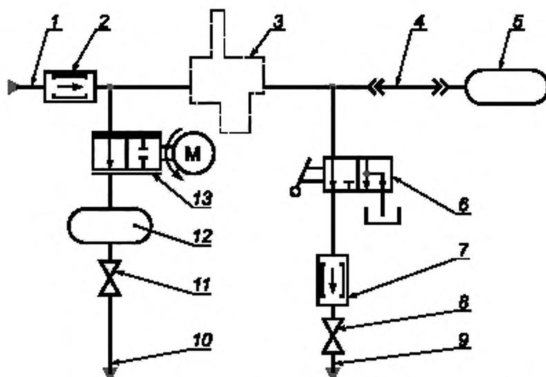
1 — магистраль нагнетания жидкости от насосной станции; 2, 7 — гаситель колебаний давления жидкости; 3 — очищаемый агрегат; 4 — трубопровод с зау́женным диаметром проходного сечения; 5, 12 — баллон блока акустической развязки; 6 — пробоотборник; 8, 11 — регулирующий вентиль; 9, 10 — магистраль слива в насосную станцию; 13 — генератор колебаний жидкости
