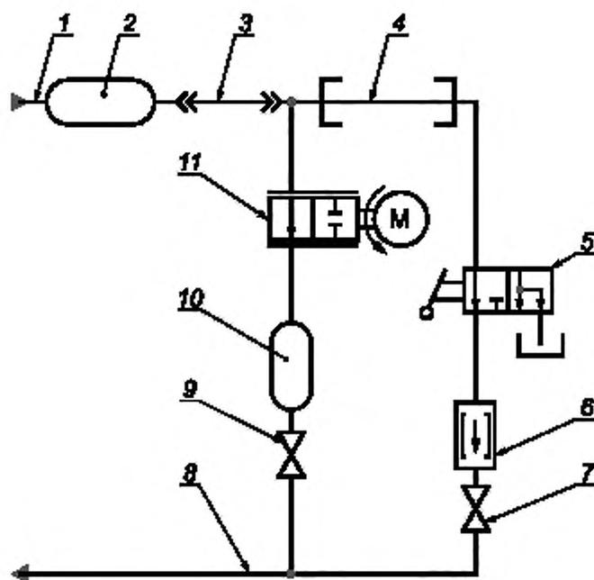
1 — магистраль нагнетания жидкости от насосной станции; 2, 10 — баллон блока акустической развязки; 3 — трубопровод с зауженным диаметром проходного сечения; 4 — очищаемая магистраль трубопровода; 5 — пробоотборник; 6 — гаситель магистраль жидкости; 7, 9 — регулирующий вентиль; 8 — магистраль слива в насосную станцию; 11 — генератор колебаний жидкости
