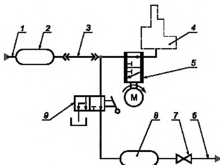
1 — магистраль нагнетания жидкости от насосной станции; 2, 8 — баллон блока акустической развязки; 3 — трубопровод с зау́женным диаметром проходного сечения; 4 — очищаемый агрегат; 5 — генератор колебаний жидкости; 6 — магистраль слива в насосную станцию; 7 — регулирующий вентиль; 9 — пробоотборник
