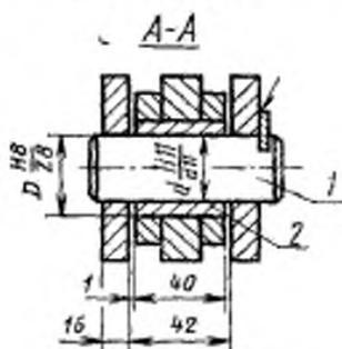
Фиксация оси при помощи шайбы
