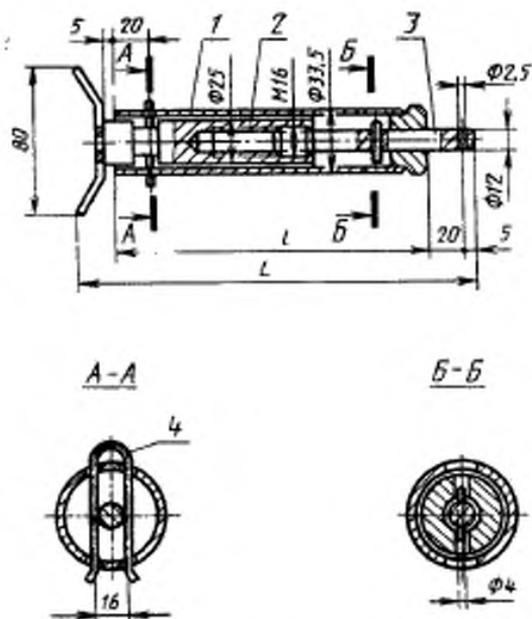
1—цилиндр; 2—фиксатор; 3—винт; 4—скоба
