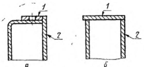
1—опорная поверхность; 2—формообразующая поверхность
