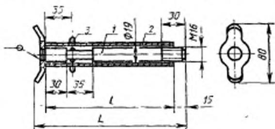
1—фиксатор; 2—труба; 3—скоба
