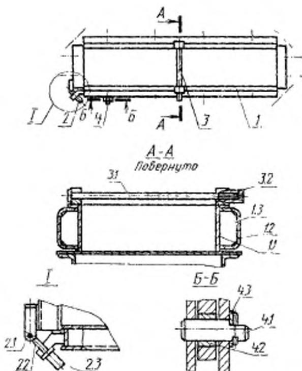
1—борт; 1.1—формообразующий элемент; 1.2—короб; 1.3—ребро жесткости; 2—замковое устройство; 2.1—ось; 2.2—болт; 2.3—гайка; 3—стяжка; 3.1—болт; 3.2—гайка; 4—шарнирное устройство; 4.1—ось; 4.2—шайба; 4.3—шайба
