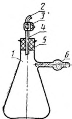
1—стопка Вуизера; 2—резиновый шланг; 3—винтовой зажим; 4—стеклянная трубка; 5—резиновая пробка; 6—хлоркальциевая трубка
