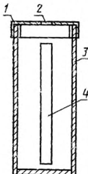
1—навинчивающаяся крышка; 2—отверстие в крышке для отбора пробы иглой; 3—корпус контейнера; 4—прорези с двух сторон в корпусе контейнера
