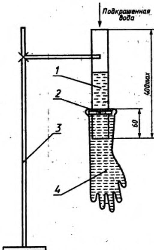
1 — цилиндр; 2 — муфта; 3 — опорная стойка; 4 — испытываемая перчатка
