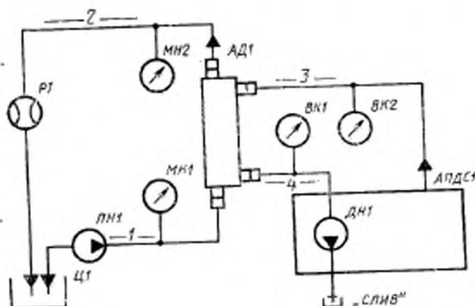
Ц1 — цилиндр; ПН1 — насос перфузата; P1 — расходомер; МН1, МН2 — манометры; АД1 — диализатор; ВК1, ВК2 — вакуумметры; АПДС1 — аппарат диализный со сливом диализата; ДН1 — насос диализата; 1 — входная магистраль; 2 — выходная магистраль; 3, 4 — магистрали диализата
