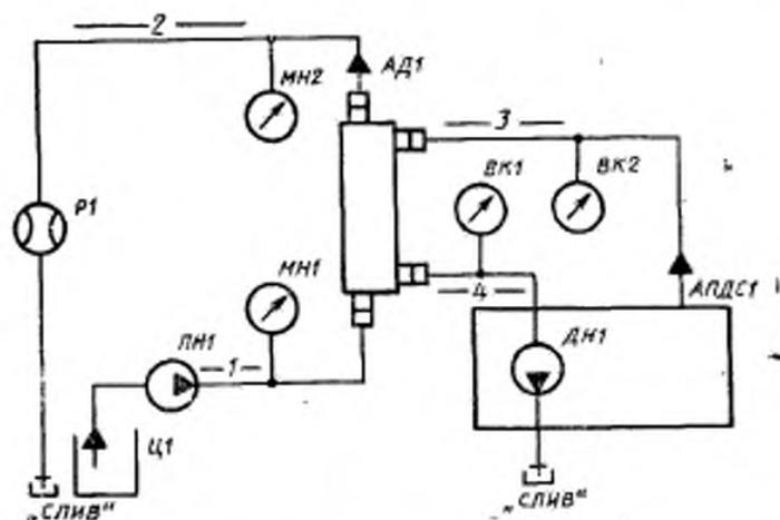
Ц1 — цилиндр; ПН1 — насос перфузата; Р1 — расходомер; МН1, МН2 — манометры; АД1 — диализатор; ВК1, ВК2 — вакуумметры; АПДС1 — аппарат диализный со сливом диализата; ДН1 — насос диализата; 1 — входная магистраль; 2 — выходная магистраль; 3, 4 — магистрали диализата
