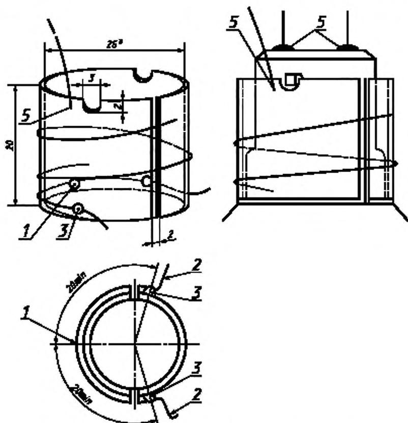
1 — рабочий конец термопреобразователя; 2 — термопреобразователь; 3 — цемент;
