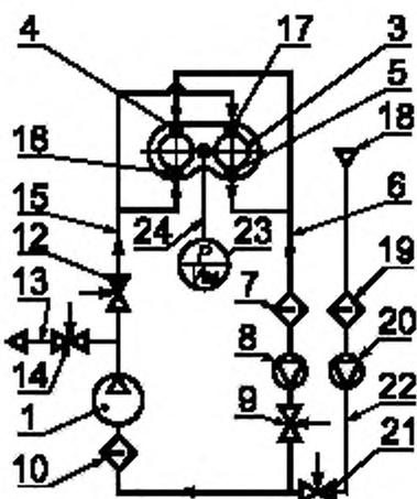
1 — автономный побудитель расхода воздуха; 3 — очки; 4, 5, 16, 17 — заборный штуцер; 6, 15, 22, 24 — соединительный шланг; 7, 9 — поглотители; 8, 20 — ротаметры; 9, 12, 14, 21 — регулировочный вентиль; 10 — очиститель воздуха; 13 — патрубок сброса воздуха; 18 — прободборник; 23 — микроманометр
