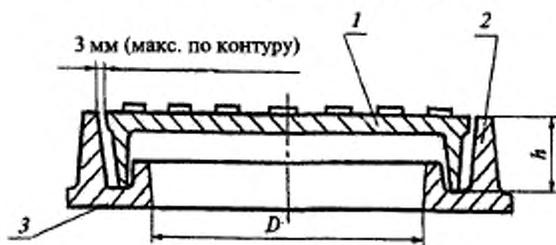
1 — крышка; 2 — корпус; 3 — опорная поверхность корпуса
