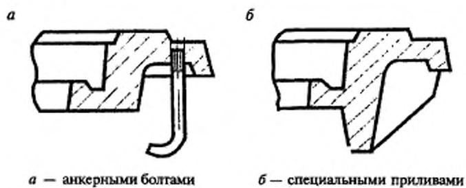
**Рисунок А.4** — Усиленная заделка корпуса люка
