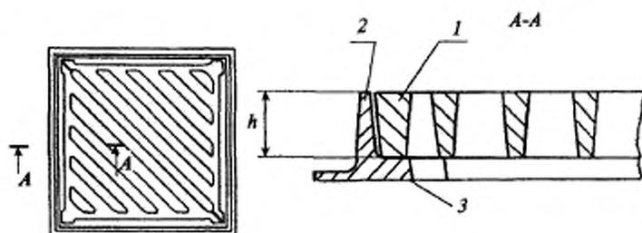
1 — крышка; 2 — корпус; 3 — опорная поверхность корпуса
