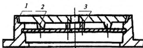
1 — корпус; 2 — крышка; 3 — замковый механизм
