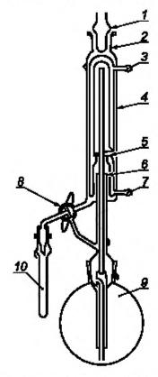
т — пробка; 2 — верхний шлиф конденсатора; 3 — верхний штуцер (слив воды); 4 — конденсатор; 5 — максимальный уровень конденсата; 8 — уровень сливной трубки; 7 — нижний штуцер (вход воды); 8 — трехходовой кран; 9 — круглодонная колба со шлифом; 10 — приемная пробирка со шлифом
