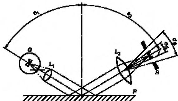
G — лампа; L<sub>1</sub>, L<sub>2</sub> — линзы; В — полевая диафрагма приемного устройства; P — лакокрасочное покрытие; ε<sub>1</sub> — угол падения, ε<sub>2</sub> — угол отражения (ε<sub>1</sub> = ε<sub>2</sub>); σ<sub>B</sub> — апертурный угол приемной системы; σ<sub>B</sub> — апертурный угол изображения источника; I — изображение нити накала
