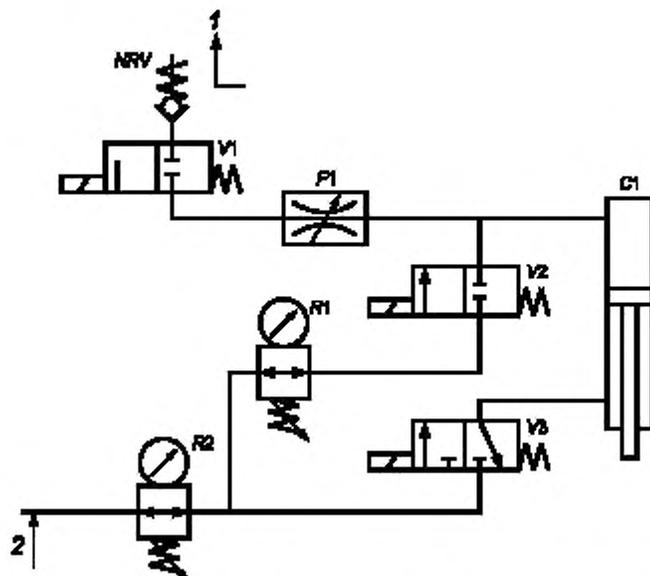
С1 — цилиндр с безмасляной смазкой, диаметром 50 мм, ходом поршня 150 мм; подаваемое количество воздуха регулируется подбором давления заполнения и/или хода поршня; *NRV* — обратный клапан; *R1*, *R2* — регуляторы давления (редукторы); *V1*, *V2*, *V3* — клапаны (вентили) с электроприводом, *F1* — вентиль регулировки скорости потока
