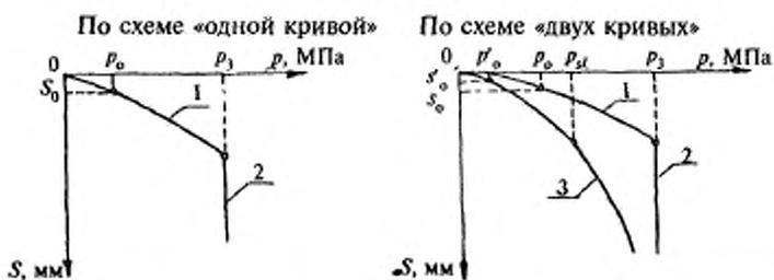
1 — осадка; 2 — просадка при заданном давлении; 3 — осадка после замачивания
