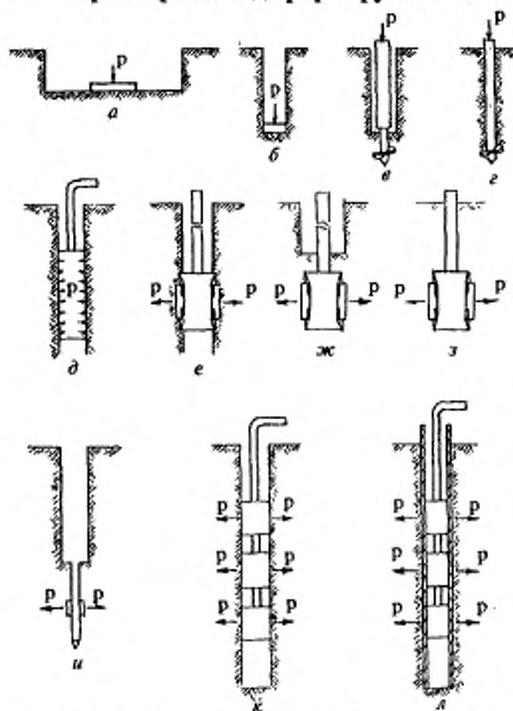
а — плоским штампом в шурфе или лунке; б — плоским штампом в забое буровой скважины; е — винтовым штампом ниже забоя буровой скважины; з — винтовым штампом в массиве; д — радиальным прессиометром; е — лопастным прессиометром в стенке скважины; ж — лопастным прессиометром ниже забоя буровой скважины; з — лопастным прессиометром в массиве; и — плоским dilatометром; к — самозабуривающимся лопастным прессиометром в скважине; л — самозабуривающимся лопастным прессиометром в скважине с обсадной трубой
