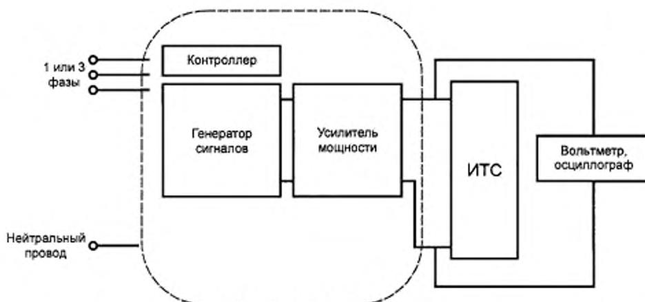
Рисунок 3 — Схема испытательного оборудования с усилителем мощности
