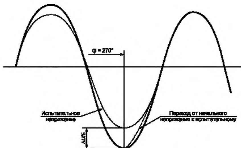
Рисунок 1в — Изменение напряжения в течение 0,25 периода при образовании  $t_r$  и  $t_f$
