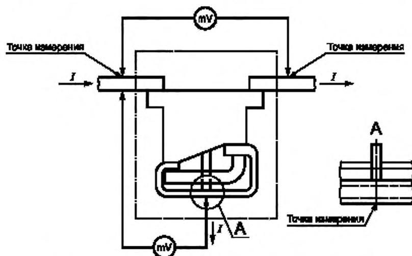
Рисунок 1 — Установка для испытания на падение напряжения
