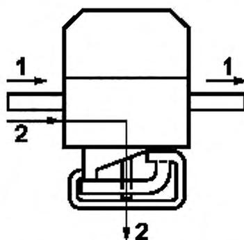
Рисунок 4 — Испытание на тепловой ток короткого замыкания
