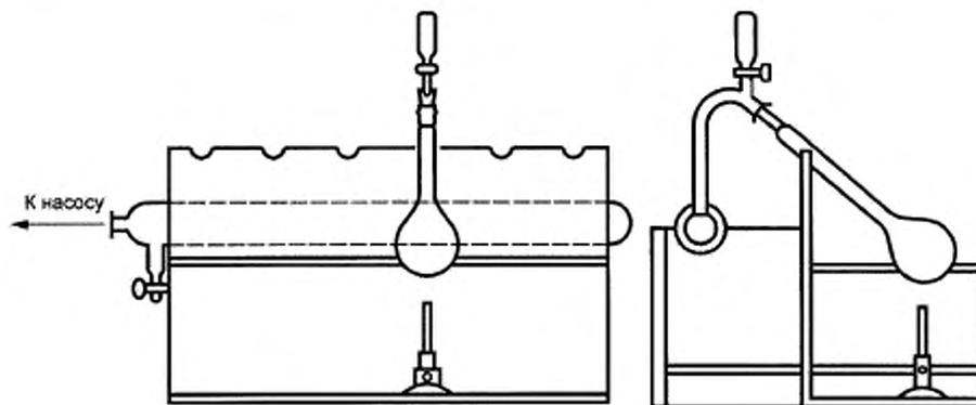
Рисунок 1 — Аппарат для мокрого окисления пробы
