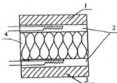
1 — нагреватель; 2 — тепломеры; 3 — холодильник; 4 — испытываемый образец
