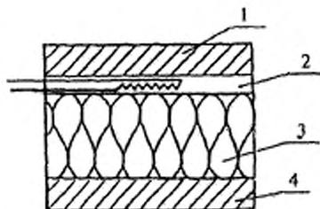
1 — нагреватель; 2 — тепломер; 3 — испытываемый образец; 4 — холодильник
