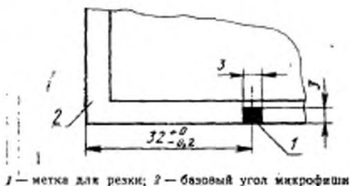
1 — метка для резки; 2 — базовый угол микрофизы
