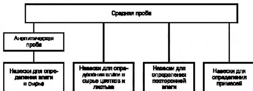
2.7.1. Навески для определения влаги в сырье выделяют из аналитической пробы предварительно измельченного сырья на отрезке длиной 1,5—2,0 см.
