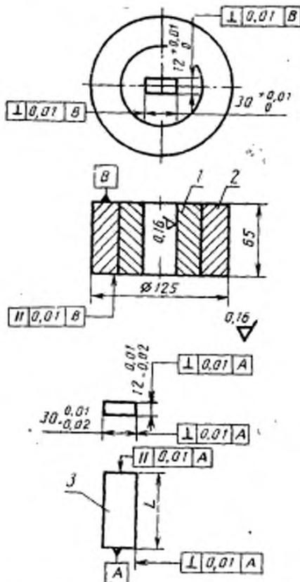
1 — стяжное кольцо; 2 — металлокерамический твердый сплав; 3 — верхний пуансон и нижний
