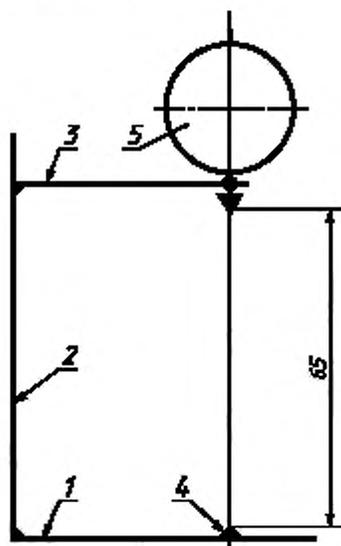
1 — основание; 2 — стойка; 3 — кронштейн; 4 — шаровая опора; 5 — индикатор
