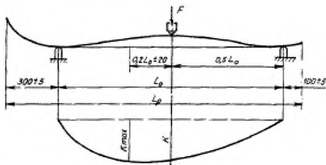
$L_0$ —расстояние между опорами,  $L_p$ —проекция длины лыжи;  $K_{\max}$ —максимальный прогиб;  $K$ —прогиб в месте приложения нагрузки;  $F$ —нагрузка
