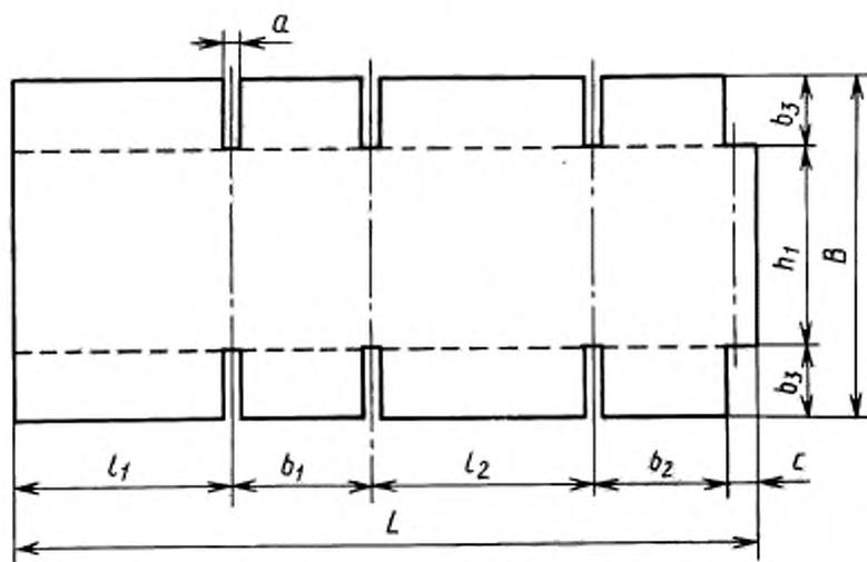
$L$  — длина развертки ящика, мм;  $B$  — ширина развертки ящика, мм;  $a$  — ширина просечек между клепками на развертке ящика, мм;  $l$ ,  $b$ ,  $h$  — внутренние размеры ящика, соответственно, длина, ширина, высота, мм;  $l_1$ ,  $l_2$ ,  $b_1$ ,  $b_2$ ,  $b_3$ ,  $h_1$  — размеры деталей развертки ящика, мм;  $S$  — припуск на линии сгиба, мм
