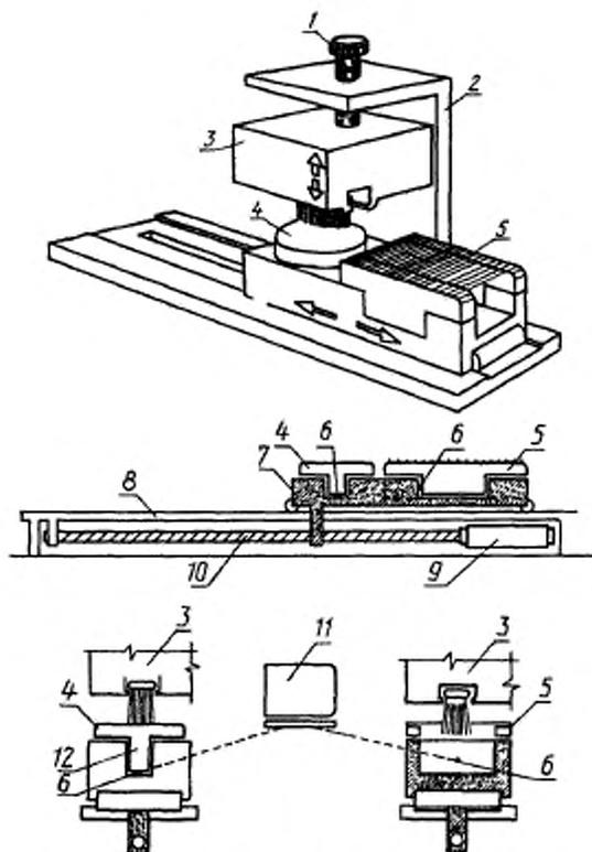
1 — регулировочный винт; 2 — компаратор; 3 — блок; 4 — пластина;
