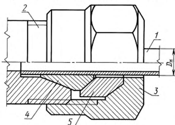
1 — труба; 2 — присоединительный конец корпусной детали с углом конуса 24° по ГОСТ 22525;
