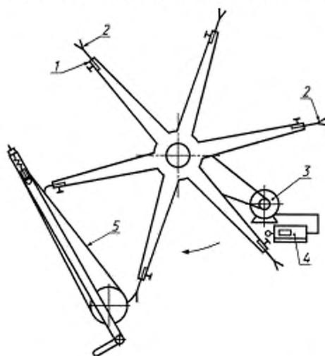
1 — зажим; 2 — элементарная проба ткани; 3 — электродвигатель; 4 — счетчик; 5 — абразив
