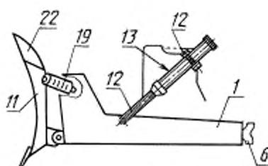
ж) Дополнительное бульдозерное оборудование
