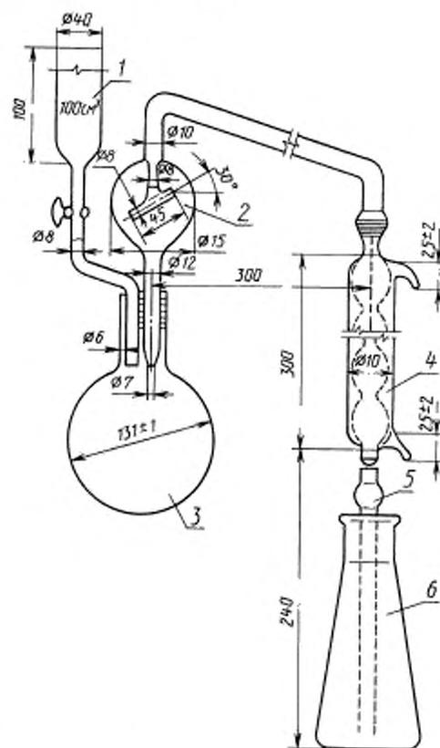
1 — цилиндрическая загрузочная воронка с крапом; 2 — предохранительный объем; 3 — круглодонная колба; 4 — холодильник;
