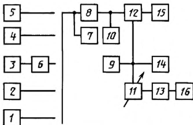
1 — имитатор телеграфных сигналов; 2 — генератор сигналов низкочастотный; 3 — генератор шума; 4 — передающее устройство измерителя переходных помех; 5 — генератор испытательных телевизионных сигналов; 6 — формирующий фильтр; 7 — квадратичный вольтметр; 8 — радиопередатчик; 9 — модулятор; 10 — измеритель мощности; 11 — аттенюатор; 12 — элемент связи (направленный ответвитель); 13 — анализатор спектра; 14 — девиометр; 15 — эквивалент антенны; 16 — частотомер
