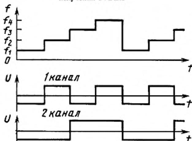
$f_1$  — частота, соответствующая «отжатию» в первом и втором каналах;  $f_2$  — частота, соответствующая «нажатию» в первом и «отжатию» во втором каналах;  $f_3$  — частота, соответствующая «отжатию» в первом и «нажатию» во втором каналах;  $f_4$  — частота, соответствующая «нажатию» в первом и втором каналах;  $U$  — манипулирующее напряжение
