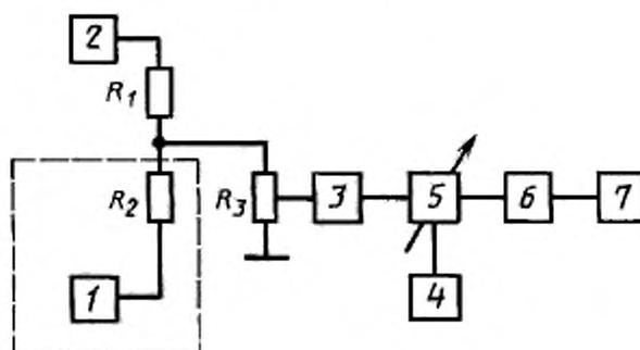
1, 2 — низкочастотные генераторы сигналов; 3 — радиопередатчик; 4 — измеритель средней или пиковой мощности; 5 — эквивалент антенны; 6 — делитель; 7 — анализатор спектра
