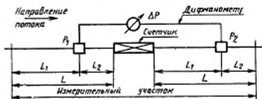
$P_1$  и  $P_2$  — отверстия для отбора давления,  $L_2 \geq 15 D$ ,  $L_1 \geq 10 D$ ,
