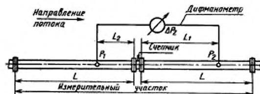
$\Delta P_2$  — потеря давления на участках трубопровода вверх и вниз по потоку и на счетчике:  $\Delta P_2 = (\Delta P_{L_2} + \Delta P_{L_1} + \Delta P_{сч})$ ;  $\Delta P_1 = (\Delta P_{L_2} + \Delta P_{L_1} + \Delta P_{сч}) - (\Delta P_{L_2} + \Delta P_{L_1}) = \Delta P_{сч}$
