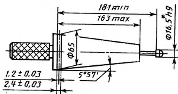
\* Для автоматической намотки этот размер необходимо согласовать между потребителем и изготовителем с учетом толщины стенки.
