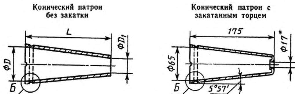
\* Для автоматической намотки этот размер необходимо согласовать между потребителем и изготовителем с учетом толщины стенки.
